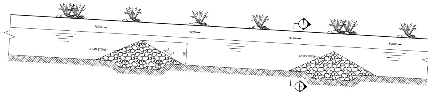
TYPICAL LONGITUDINAL SECTION THROUGH DRAINAGE WITH CHECK WEIRS
